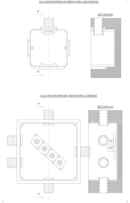
CAJAS DE CONEXION Y MECANISMOS DE EMPOTRAR
