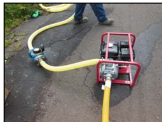
Foto n° 1.- Detalle de la motobomba y contador empleados para la realización de ensayo Lefranc.
