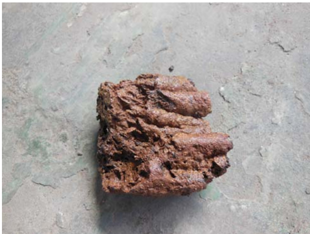
Foto nº 12 Lavas cordadas atravesadas en los sondeos realizados.
