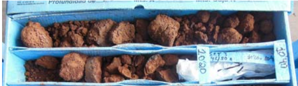
Foto n° 6 Aspecto que presenta los suelos arenos limosos en el sondeo S-7.
